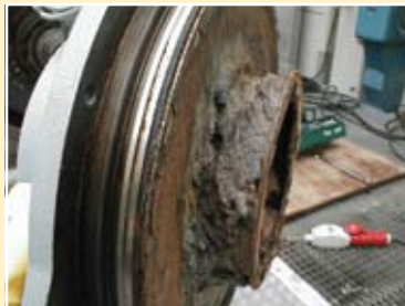
Повреждения, вызванные отложениями в зоне сброса фильтрата с центрифуги.
