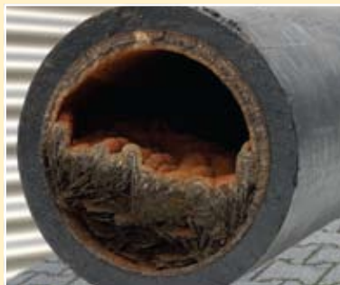
Отложения из карбонатов / окислов железа.
