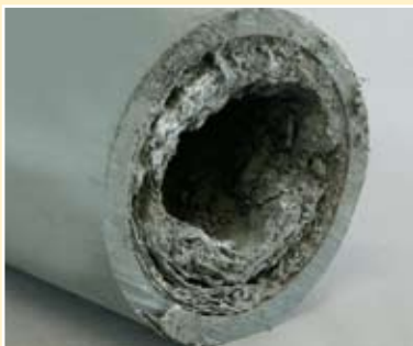
Отложения из карбонатов / окислов железа с органическими компонентами.
