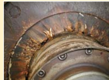
Повреждения, вызванные отложениями в зоне сброса фильтрата с центрифуги.
