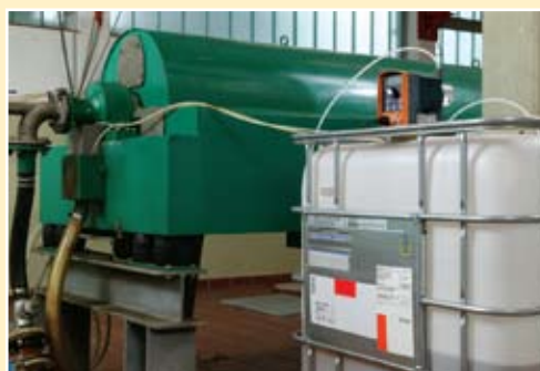
На рисунке показан неразбавленный реагент Polystabil, добавляемый с помощью мембранного насоса в слив фильтрата центрифуги.
