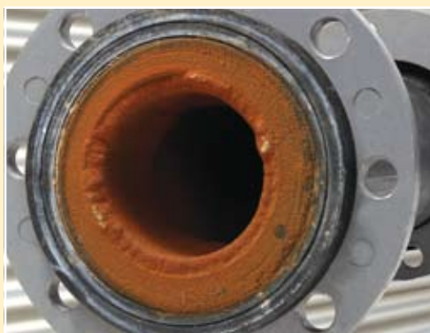
Карбонатные отложения с высоким содержанием оксидов железа.
